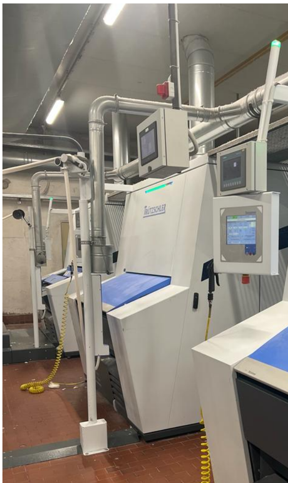
Foto 1 – Imagem da máquina de carda TC15, marca Trützschler.
